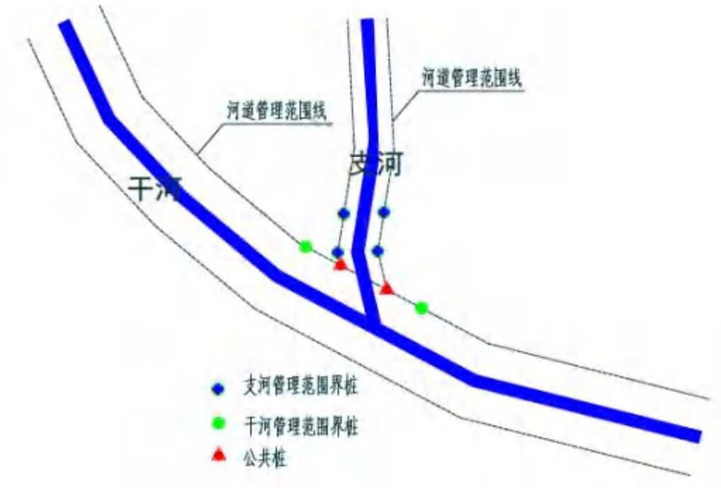
图 4.3-1 干支流交汇有控制性建筑物
