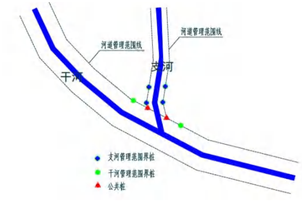
图 4.3-1 干支流交汇有控制性建筑物
