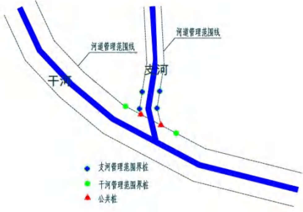
图 4.3-1 干支流交汇有控制性建筑物
