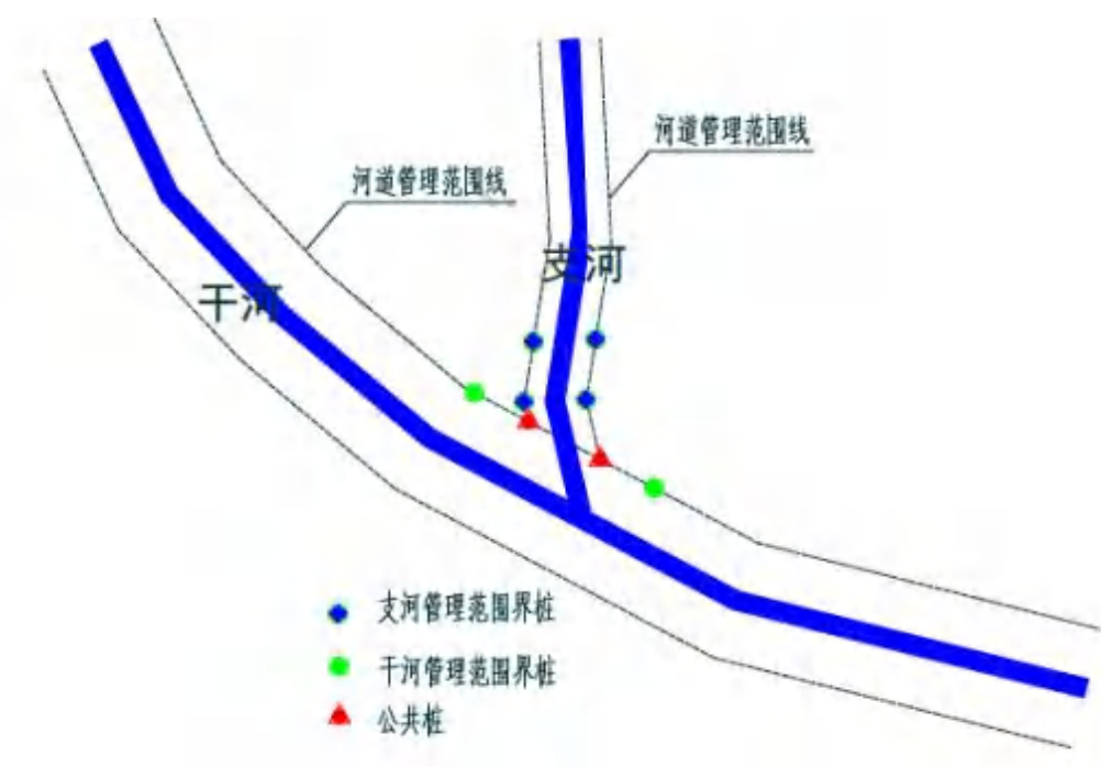
图 4.3-1 干支流交汇有控制性建筑物
