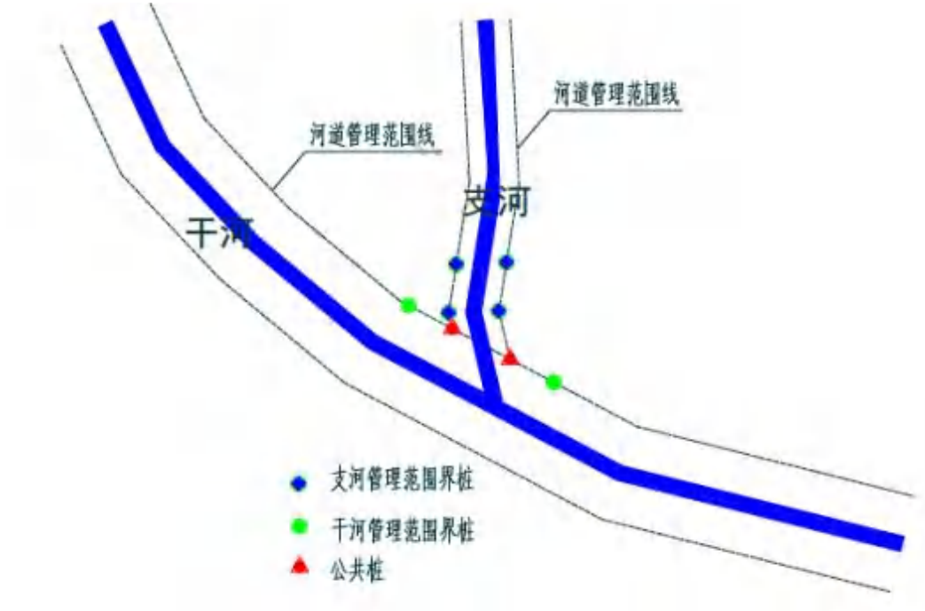
图 4.3-1 干支流交汇有控制性建筑物
