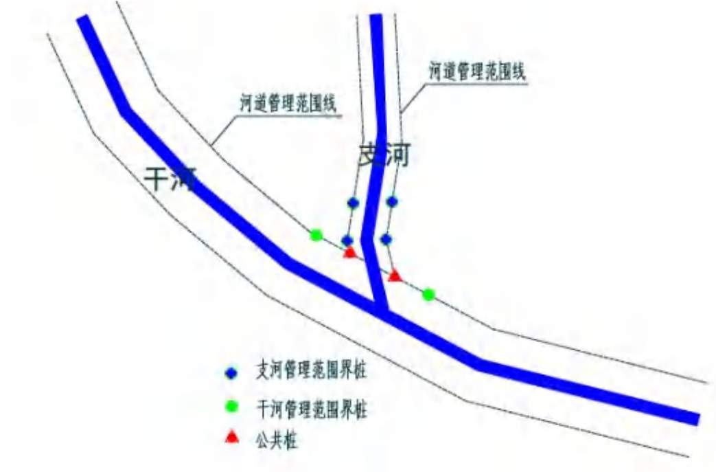
图 4.3-1 干支流交汇有控制性建筑物
